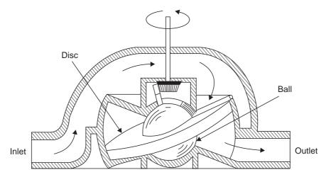
Fig. 1.28 Nutating disk meter
