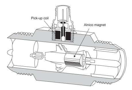
Fig. 1.34 Turbine Flow meter
