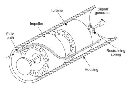
Fig. 1.40 Impeller turbine mass flow meter
