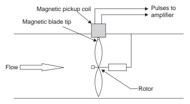
Fig. 1.33 A simple Turbine Flow meter
