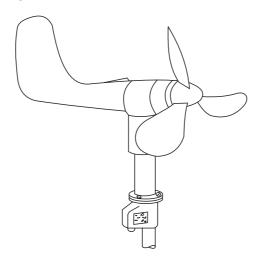
Fig. 1.82 Impeller-anemometer.
