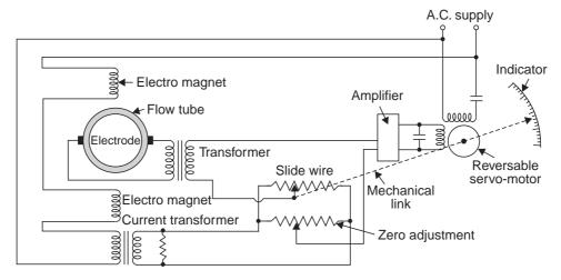
Fig. 1.52 Electromagnetic flow meter
